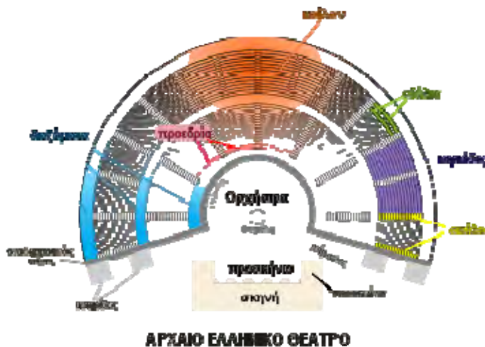
Ε.3.13. Κάτοψη αρχαίου ελληνικού θεάτρου και τα μέρη σκηνής, ορχήστρας και κοίλου.
